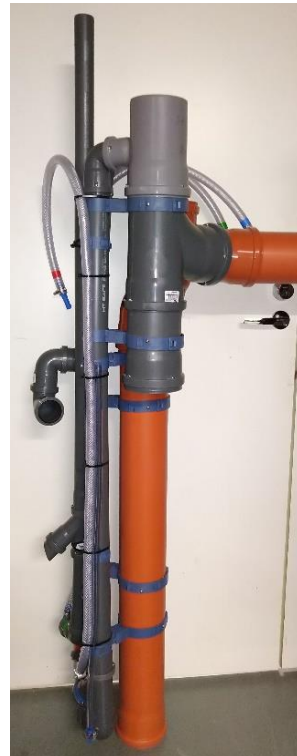
Ilmastuslautanen (2-3 kpl) Tulevan jäteveden putkisto Näytteenottoaivo Mammut-putkisto
