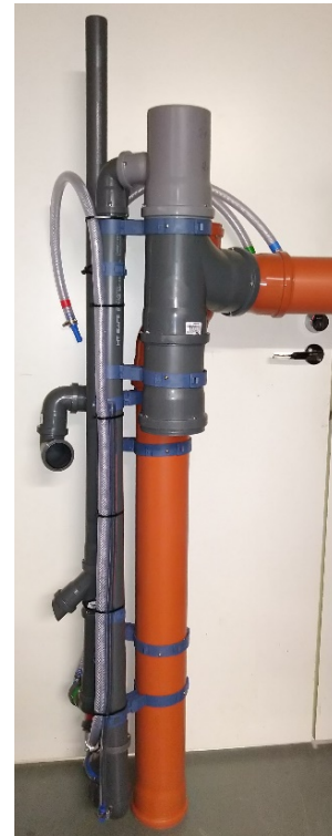
Ilmastuslautanen (2-3 kpl) Tulevan jäteveden putkisto Näytteenottoaivo Mammut-putkisto
