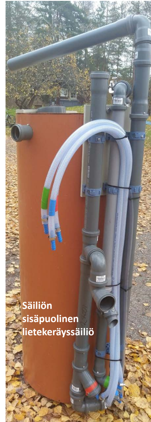
Ilmastuslautanen (2-3 kpl) Tulevan jäteveden putkisto Näytteenottoaivo Mammut-putkisto
